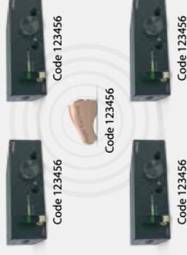
El software Roger Network Clone Tool permite compartir los datos de conexión entre diversos transmisores Roger BaseStation. Los Roger BaseStations tienen códigos digitales individuales para permitir su conexión con los Earpieces. Sin embargo, cuando se necesita conectar un Roger Earpiece en un número de zonas cubiertas por diferentes BaseStations, es posible dar a todos los BaseStations un código compatible entre ellos mediante el software Roger Network Clone Tool.
